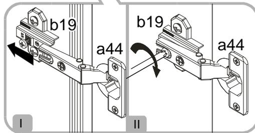
Regulacja drzwi / Seřizování frontálních dílů
